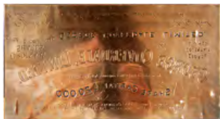
MATRIZ DE RELEVO TIMBRADO, GRAVADA À MÃO EM CHAPA DE COBRE
