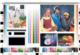
UMA ESCALA DE CORES PADRONIZADA É IMPRESSA NAS MÁQUINAS OFFSET ROTATIVAS E PLANAS (ABAIXO, A ESCALA DE CORES IT/8).
